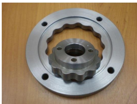
Рисунок 2.1.12. Пример изготовления кулачка на аппаратно-программном комплексе
